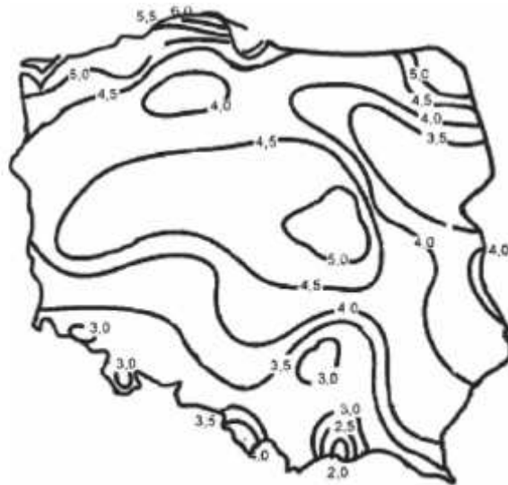
Rys. 1 Mapa zasobów wiatru wg pomiarów IMCW na wysokości 30 m n.p.g. dla terenu o klasie szorstkości „0-1”
